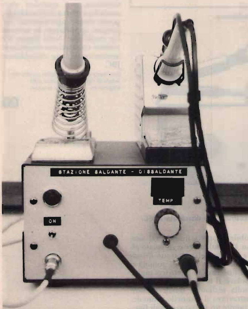
⑥ Pannello frontale della stazione dissaldante.
